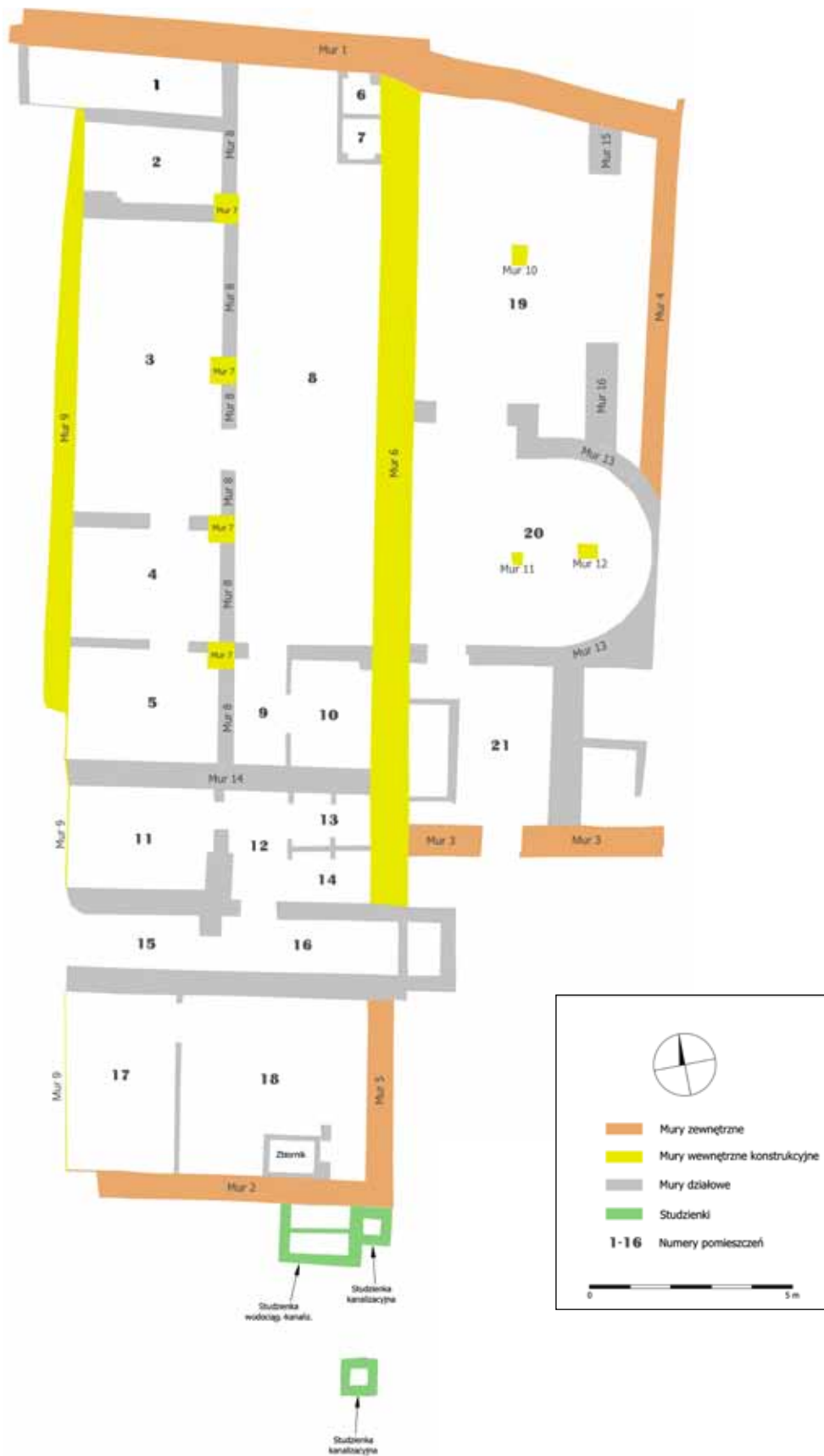
Ryc. 152. Trzy grupy murów kamienicy przy ul. Św. Ducha 43 w VIII poziomie osadniczym. Rys. A. Grabska, E. Nakonieczna i P. Makuła Fig. 152. Three groups of walls of the house at 43 Św. Ducha Street, occupation level VIII. Drawing by A. Grabska, E. Nakonieczna, P. Makuła
